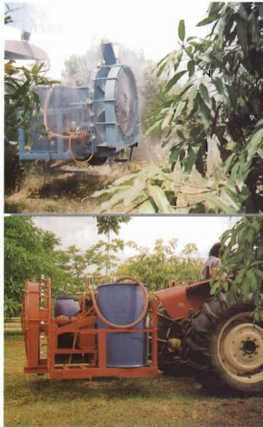
ไปยังชุดหัวฉีด น้ำยาภายใต้ความดันที่ปรับตั้งไว้ประมาณ 30 บาร์ จะถูกฉีดออกทางหัวฉีดเป็นม่านละอองชนิดกรวยกลวง พัดลม propeller จะดูดอากาศเข้าทางด้านหลัง ลมที่ถูกดูดผ่านใบพัดออกไปจะปะทะกับแผ่นเปลี่ยนทิศทางลม  $90^\circ$  มีผลให้ลมพุ่งออกไปตามแนวรัศมีของใบพัดโดยรอบด้วยความเร็ว 180
